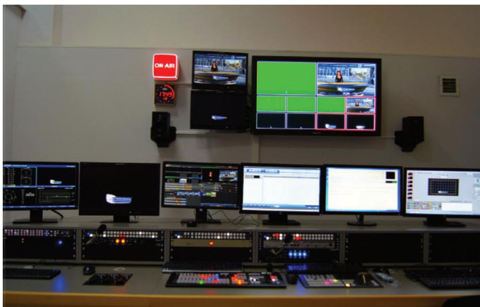
АПБ в данном проекте совмещен с ЦА и предназначен для формирования программы одного телевизионного канала и выдачи в эфир подготовленного материала по сформированному расписанию, а также для осуществления распределения сигналов внутри комплекса. В основе АПБ матричный коммутатор - AJA KUMO 3232, видеосерверы и графическое оформление - Dayang, аудио-видеомикшер Panasonic AG-HMX100.
