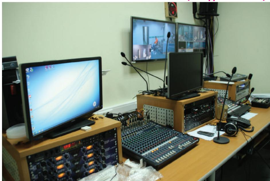
ния, трансляции изображения с видеокамер одного зала в другой. Система коммутации выполнена на основе высококачественного матричного коммутатора Profitt PVP-1616HDSI. Коммутаторы серии 16X предназначены для коммутации композитных и компонентных видеосигналов и аудио моно- и 2-канальных сигналов.
